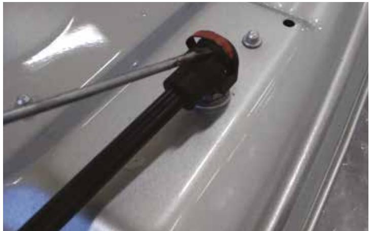
**FR** 6. Dévissez les quatre vis de fixation du capot à l'aide du cliquet et de la douille de 13 mm. Déposez le capot d'origine.
