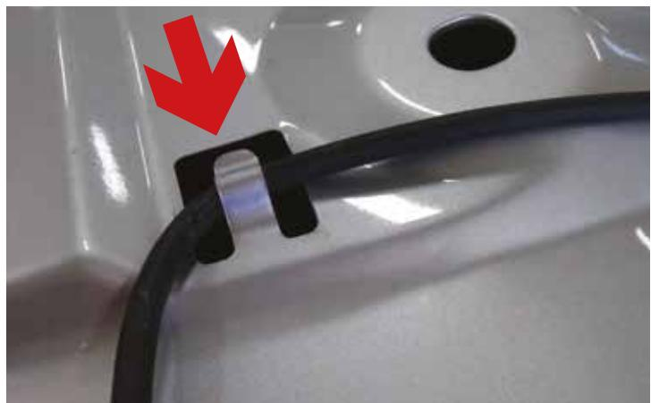
**FR** 5. Soulevez le clip sur la base du vérin à l'aide d'un tournevis plat de 3 mm (ne pas le retirer complètement) et tirez le vérin pour le sortir de son emplacement. **Attention, sans le vérin, le capot n'est plus maintenu en position ouverte, veuillez à le sécuriser en position ouverte avant de procéder à la suite du démontage.**
