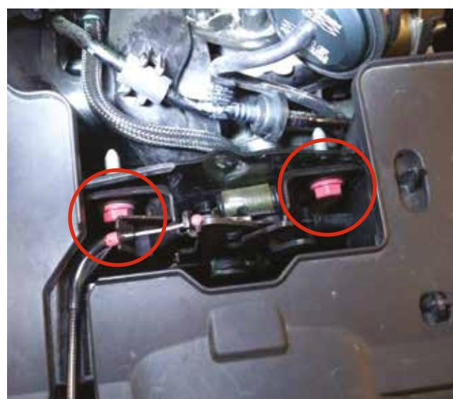
**FR** 18. Lors de la fermeture du capot, vérifiez l'espace avec les essuis glaces. S'il y a contact entre ces deux éléments lorsque les essuis glaces sont en marche, modifiez leur position en desserrant les écrous de fixation à l'aide d'une douille de 16 mm.
