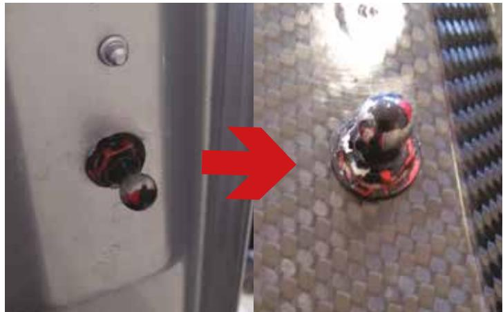
**FR** 12. Remontez la protection acoustique sur le capot en fibre de carbone à l'aide des clips du capot d'origine.
