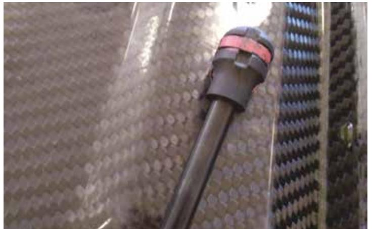
**FR** 16. Fixez la durite sur le capot côté passager à l'aide des cavaliers présents sur le capot et de rislans. Ne pas trop serrez les rislans pour ne pas déformer les durites. Coupez l'excédent une fois le rislan en place.
